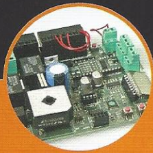
Centrale di comando con ricevitore. Control board with receiver.
